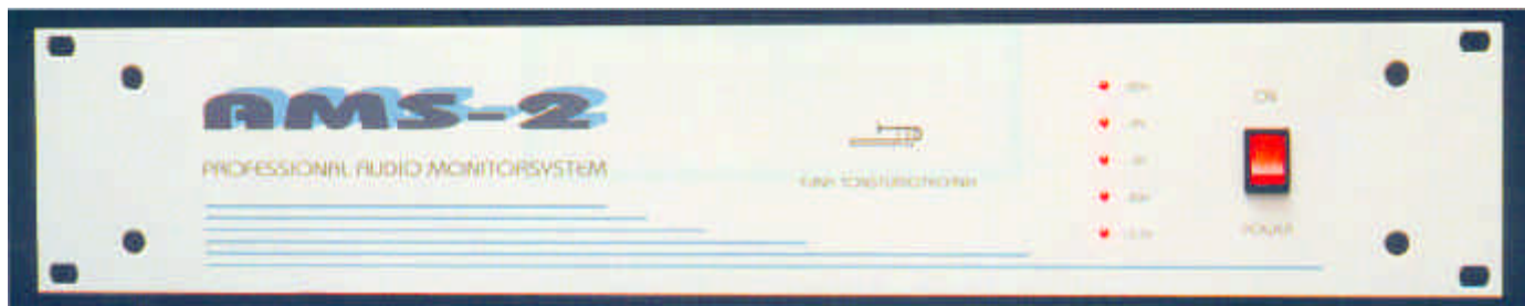
Bild 2: Das Bedienfeld wird durch eine 19-Zoll-Einheit für Rackeinbau ergänzt. Sie enthält den Großteil der Steuer- und Signalelektronik. Die Entfernung zwischen beiden Geräten kann bis zu 15m betragen
