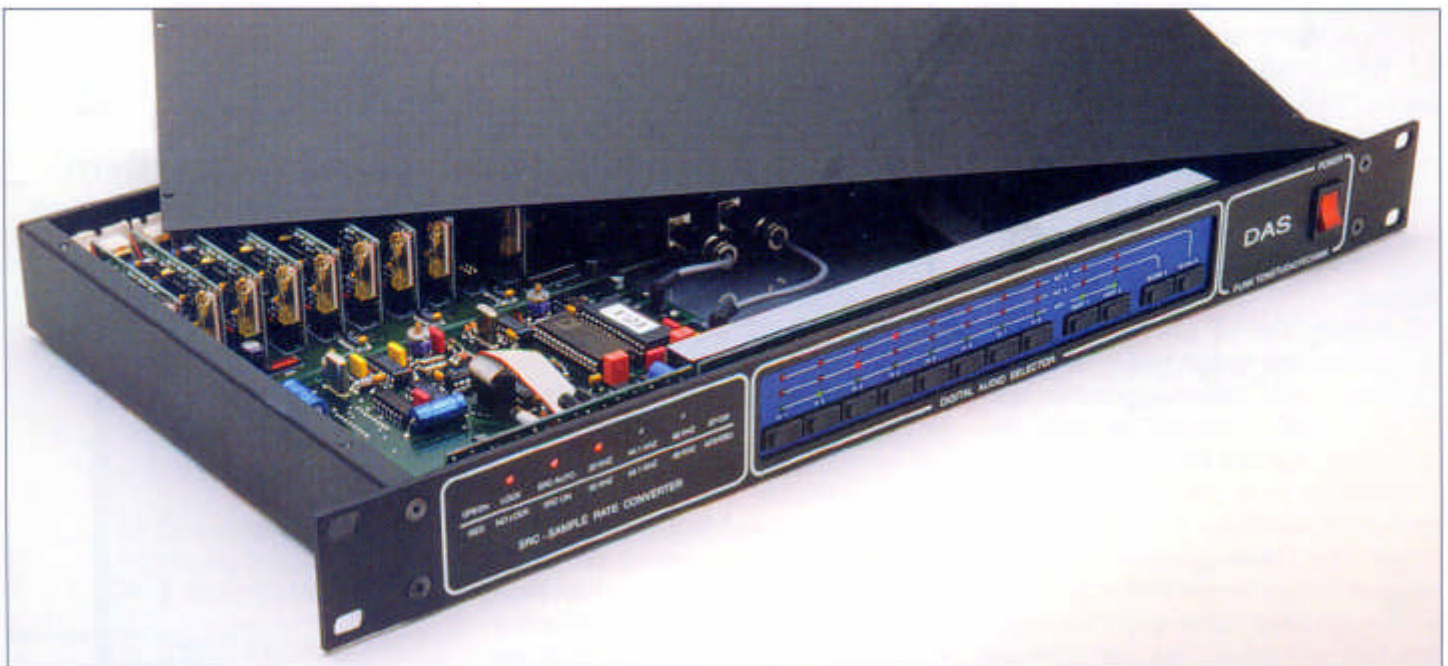
Bild 1: Formatkonversion, Abtastratenwandlung, SCMS-Manipulation und Signalmatrix in einem einzigen Gerät: DAS von Funk Tonstudioteknik Berlin
