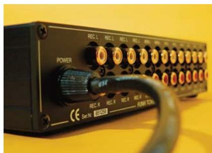
Das Netzkabel ist beim Lap – im Gegensatz zum MTX – fest montiert
