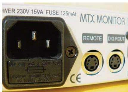
An den MTX kann neben einem separatem Netzkabel eine optionale Fernbedienung angeschlossen werden
