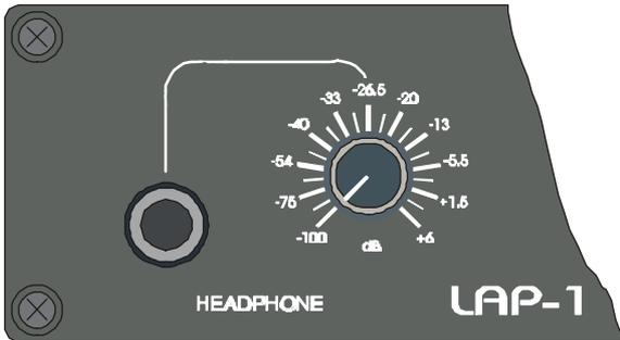
Der integrierte Kopfhörerverstärker ist sowohl für niederohmige als auch für hochohmige Kopfhörer mit 6,3mm-Stereoklinkenstecker geeignet. Das Kopfhörersignal ist über die Stereo-Klinkenbuchse auf der Frontplatte zugänglich.
