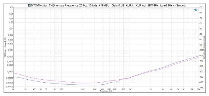
Dieser Messschrieb zeigt die besonders geringen THD-Verzerrungen über den Audiofrequenzbereich von 20 Hz bis 10 kHz. Diese Messung jetzt aber bei hohem Studio-Leitungspegel von +18 dBu. Bei 1 kHz erreichen die THD-Werte typ. -125 dB bzw. 0,000055 %!
