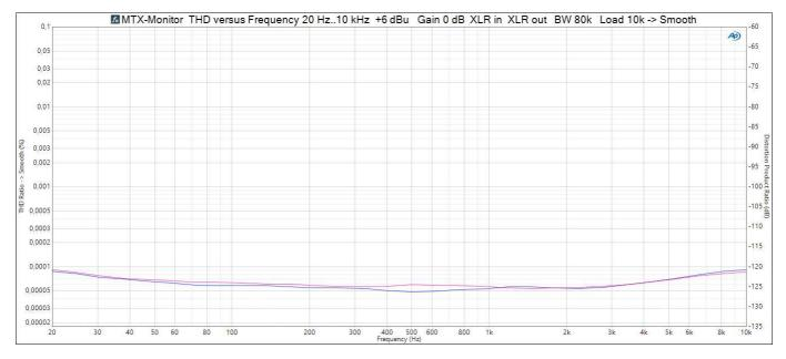
Dieser Messschrieb zeigt die besonders geringen THD-Verzerrungen über den Audiofrequenzbereich von 20 Hz bis 10 kHz bei üblichem Studio-Leitungspegel von +6 dBu. Bei 1 kHz erreichen die THD-Werte typ. -125 dB!
