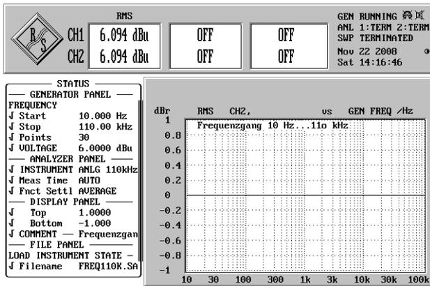
Frequenzgang 10 Hz...110 kHz (Skala +/- 1 dB)
