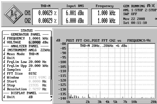
THD+N bei 1 kHz Messbandbreite 22 Hz...22 kHz
